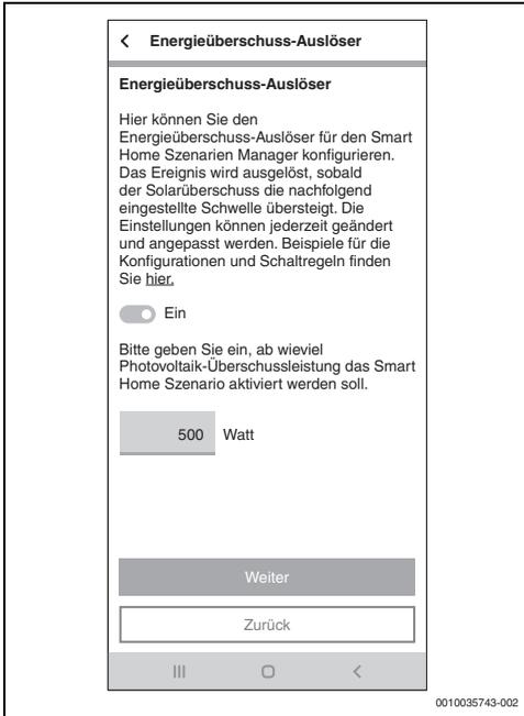
Bild 34 Funktion Energieüberschuss-Auslöser
