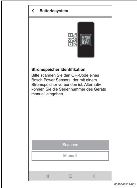
Bild 32 Stromspeicher Identifikation
