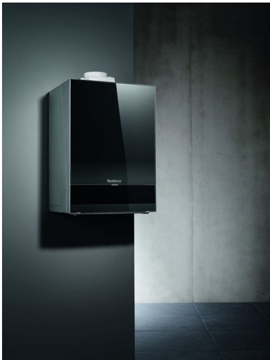
Abb.5: Erfüllungsoption flüssige, gasförmige oder feste Biomasse, Wasserstoff (H 2 ): Das Buderus Gas-Brennwertgerät Logamax plus GB192i ist Green Fuels Ready für bis zu 100 Prozent Biomethan (nach G260) und für den Betrieb mit bis zu 20 Prozent Wasserstoff im Erdgas vorbereitet.
